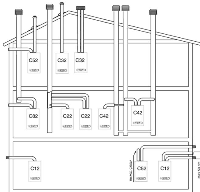
**КОАКСИАЛЬНЫЕ ДЫМОТВОДЫ/ВОЗДУХОВОДЫ (Ø60/100 мм)**
