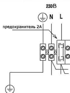
Подключение к сети электропитания должно осуществляться через отдельный автоматический выключатель с зазором контактов не менее 3 мм и номиналом не более 4 А. При техническом обслуживании необходимо выполнять операции, требующие полного отключения питания от котла. Поэтому, если нет возможности установить автоматический выключатель в непосредственной близости от котла рекомендуется установить рядом с котлом промежуточный выключатель или хотя бы розетку.
