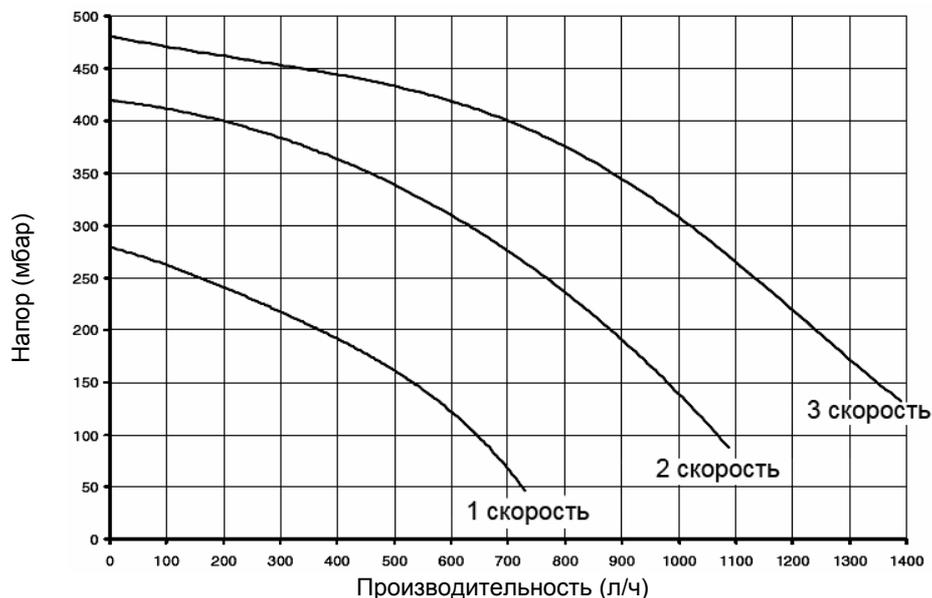
Если гидравлическое сопротивление контура отопления не может быть преодолено с помощью стандартного насоса возможна установка **циркуляционного насоса в увеличенном напоре (артикул 1101979)** или использование **гидравлического разъединителя (артикул 1102519)**
