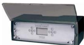
**CL-M** – управление модуляционной, одно- или двухступенчатой горелкой, встроенным или отдельно стоящим бойлером-аккумулятором. Каскадное управление как одним котлом, так и группой до четырех котлов. Возможность управления 6-ю отдельными контурами отопления (при заказе дополнительных блоков управления).
