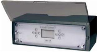
Пульт управления **CL-M** используемый с котлами **RIELLO TAU N** учитывает как различные потребности отопительной системы в целом, так и отдельных устройств из которых она состоит. Он позволяет управлять модуляционной, одно- или двухступенчатой горелкой, отдельно стоящим бойлером аккумулятором ГВС. Возможно каскадное управление системой включающей до 4 котлов с 18 отдельными контурами отопления (при заказе модулей управления отдельным контуром).
