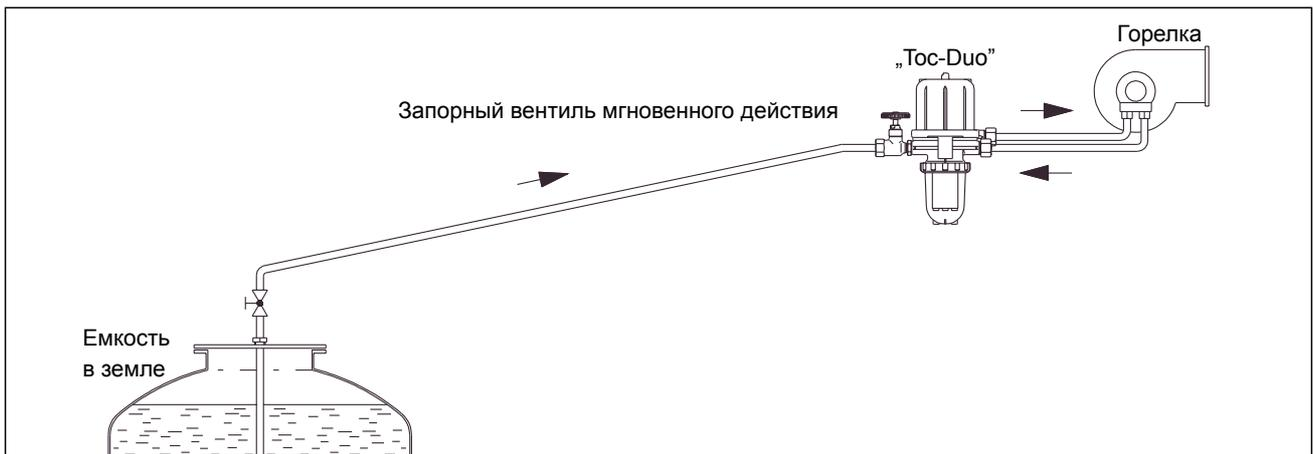
Трубопроводы присоединяются с помощью запорных вентиляей (см. рисунки).
